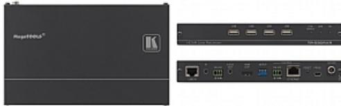
TP-590RXR ist ein Hochleistungs-Empfänger mit HDBaseT 2.0 Technologie für 4K @60 UHD HDMI, USB 2.0, Ethernet, Stereo-Audio, bidirektionales RS-232 und IR mit vergrößerter Reichweite. Dabei ist die Übertragungsreichweite 100 m, bei geringerer Auflösung auch darüber hinaus. Das Gerät empfängt das HDBT Twisted Pair Signal vom Übertrager TP-590TXR über CAT Kupferkabel und dekodiert es zurück in 4K 60 HDMI, USB, Ethernet, Stereo-Audio, RS-232 und IR Signale
