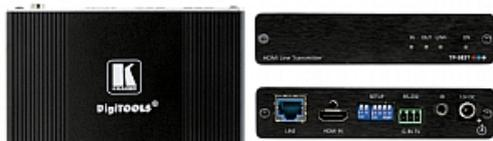
TP-583T ist ein leistungsstarker HDBaseT-Sender mit hoher Reichweite für 4K-HDR-HDMI-, RS-232- und IR-Signale über verdrehte Doppelleitungen. TP-583T wandelt alle Eingangssignale in das übertragene HDBaseT-Signal um. Es überträgt Videosignale über Kramer-Kupferkabel auf bis zu 70 m (230 ft) bei bis zu 4K@60Hz (4:4:4) Videoauflösungen. Es ist mit Standard-HDBaseT-kompatiblen Extendern bei 4K@30Hz und HD-Videoauflösungen kompatibel
