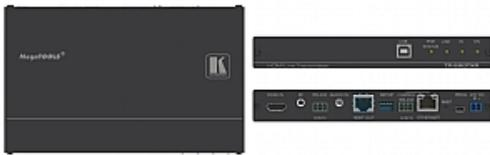
TP-590TXR ist ein Hochleistungs-Übertrager mit HDBaseT 2.0 Technologie für 4K @60 UHD HDMI, USB, Ethernet, Stereo-Audio, bidirektionales RS-232 und IR mit vergrößerter Reichweite über CAT Kupferkabel. Dabei ist die Übertragungreichweite 100 m, bei geringerer Auflösung auch darüber hinaus. Das Gerät wandelt die Eingangssignale in ein HDBaseT Twisted Pair Signal, das an einen Empfänger TP-590RXR zur Dekodierung übertragen wird
